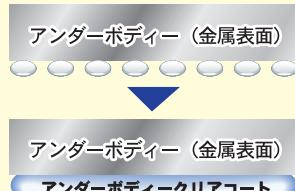
2 融雪剤や海水・潮風に含まれる成分（塩化カルシウム・塩化ナトリウム）と化学反応して防錆皮膜が形成されます。
